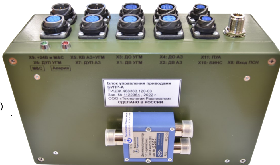
Рисунок 9 – Блок управления приводами антенны БУПР-А
