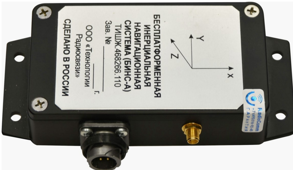
Рисунок 11 – Внешний вид БИНС-А ТИШЖ.468266.110
