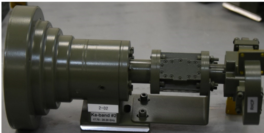
Рисунок 16 - Внешний вид двухпортового облучателя Ka-диапазона №2 (17,70 - 20,20) ГГц с круговой поляризацией
