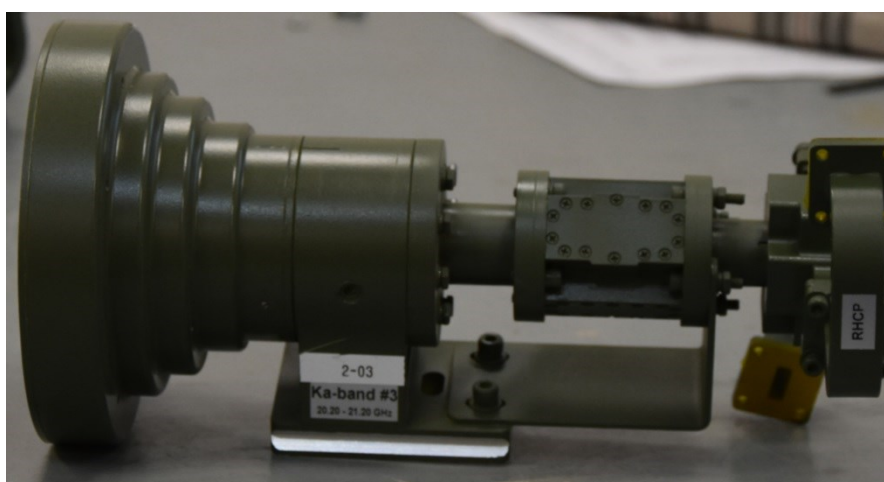
Рисунок 17 - Внешний вид двухпортового облучателя Ka-диапазона №3 (20,20 - 21,20) ГГц с круговой поляризацией
