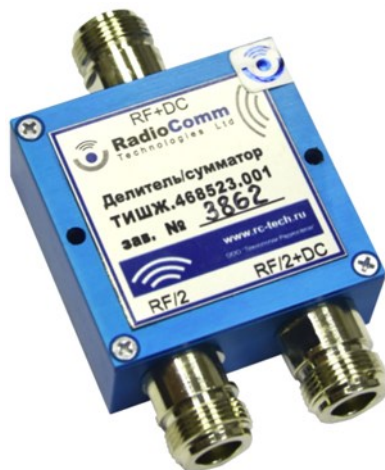
Рисунок 10 – Делитель/сумматор 1/2 L-диапазона ТИШЖ.468523.001
